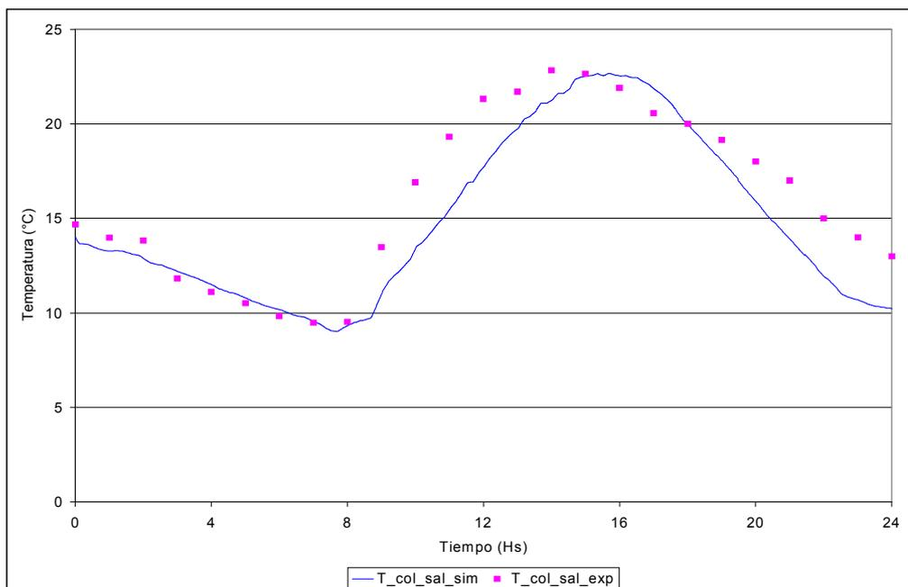
Figura 5. Datos experimentales y simulados de la temperatura del fluido a 30m dentro del túnel.
