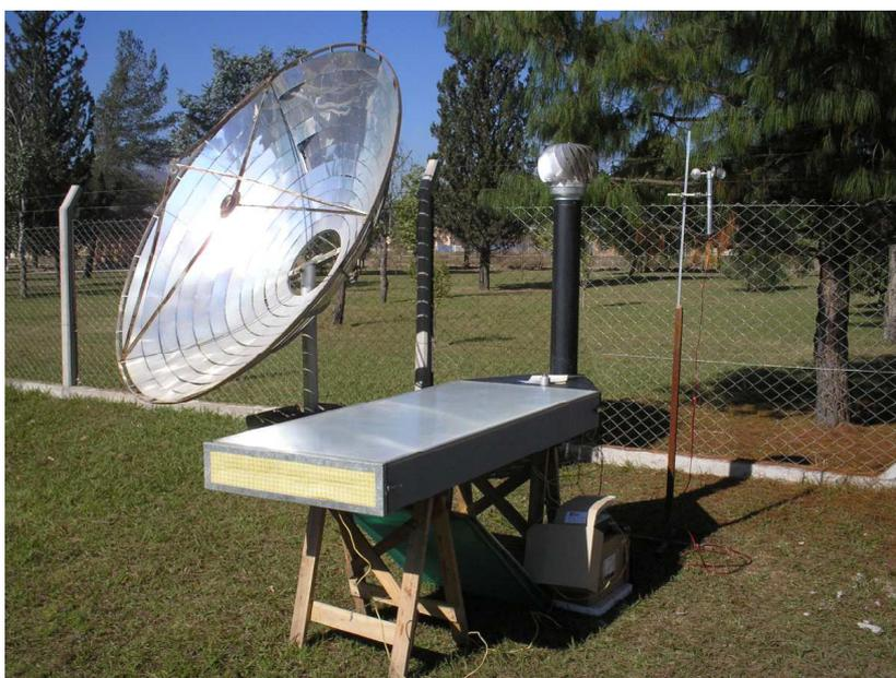
Figura 3: Secador solar ensayado, con chimenea y extractor eólico.
