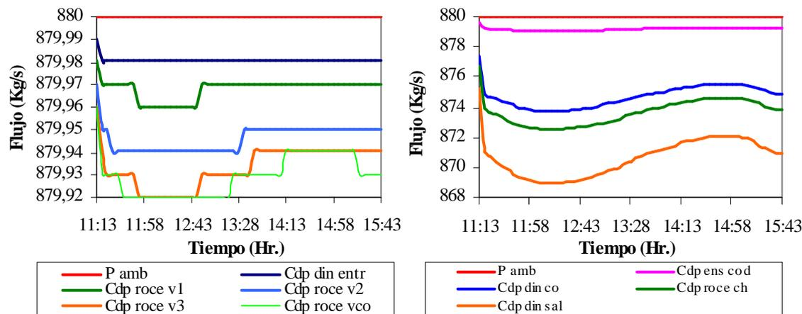
Figuras 6: Caídas de presión en la cámara de secado (izquierda) y en la chimenea (derecha).
