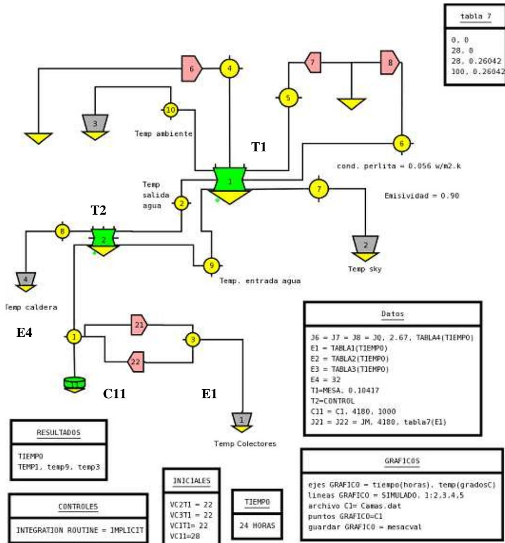
Figura 3: Esquema generado con DIA para la Hipótesis "a" de la simulación
