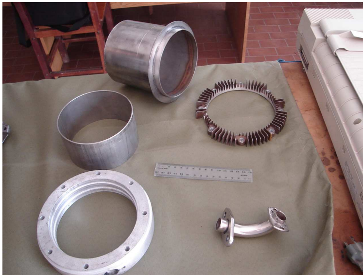
Fig. 10.- Muestra un despiece complementario, donde se aprecia la camisa del pistón de desplazamiento y sus accesorios.
