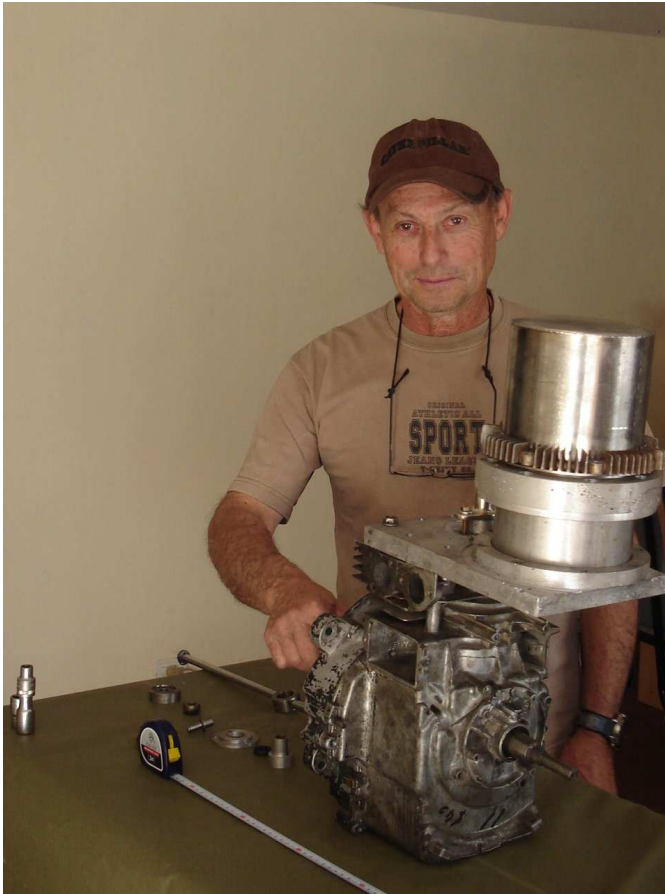
Fig. 8.- Muestra el estado actual de construcción del prototipo de motor Stirling sostenido por el Sr. Alcorta.
