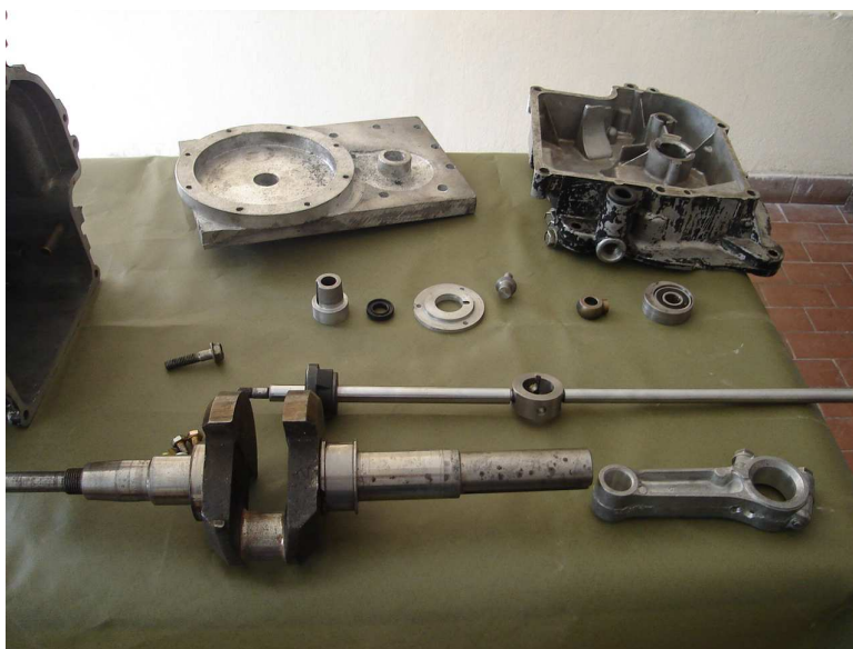
Fig. 9.- Muestra el estado actual del despiece del motor Stirling sin la camisa del pistón de desplazamiento
