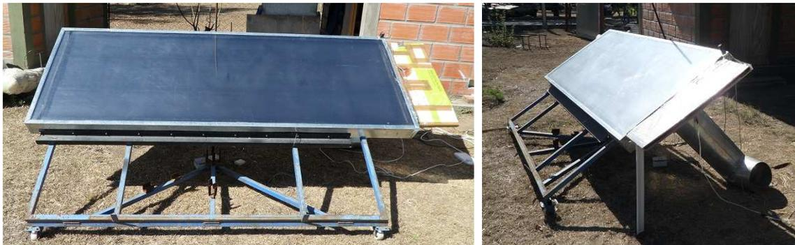
Figura 1: Foto del colector solar de aire de doble flujo mientras se ensayaba los días 4, 7 y 8 de noviembre 2011
