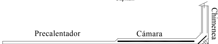
Fig. 2: Esquema del secador simulado. El grafico no tiene esta realizado a escala.
